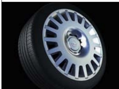
▲ Cerchio in acciaio da 6,5J x 15, copriuota con disegno a 18 raggi e pneumatici da 195/65 R 15.
